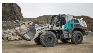
Wasserstoff-Radlader im Praxistest bei Gratkorn © STRABAG / Stefan Bock
